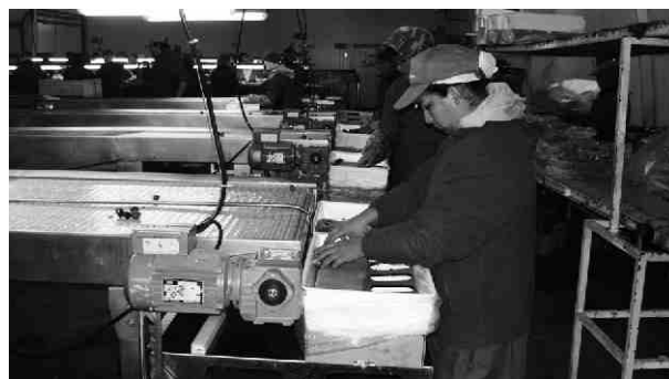
Proceso de cerezas. Máquina calibradora electrónica en agua
